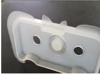
图3 带飞边的塑件
