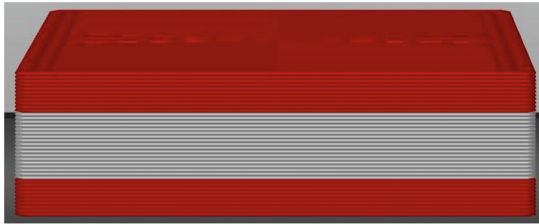
Fig. 3. ABS-PLA sandwich test specimen
