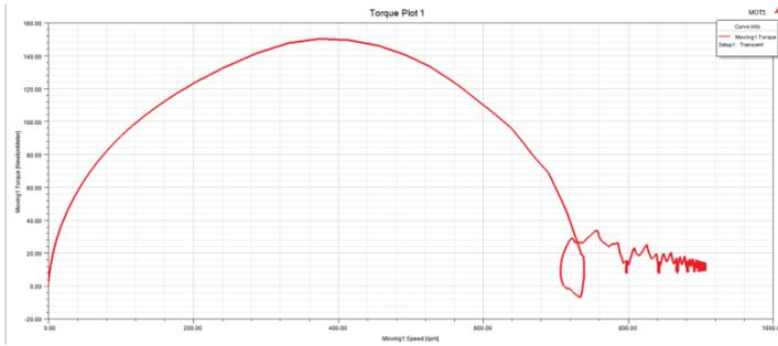
**Fig. 6** Kvasi Torque charakteristic
