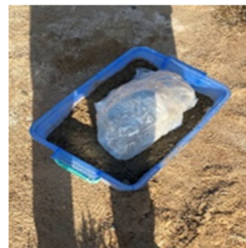
(d) Packaging soil samples.
