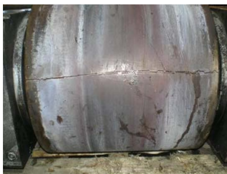
Fig.1. Longitudinal cracks on rollers
