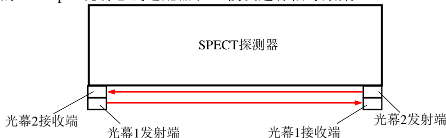
图4 基于双层光幕传感器的人体轮廓测量原理
